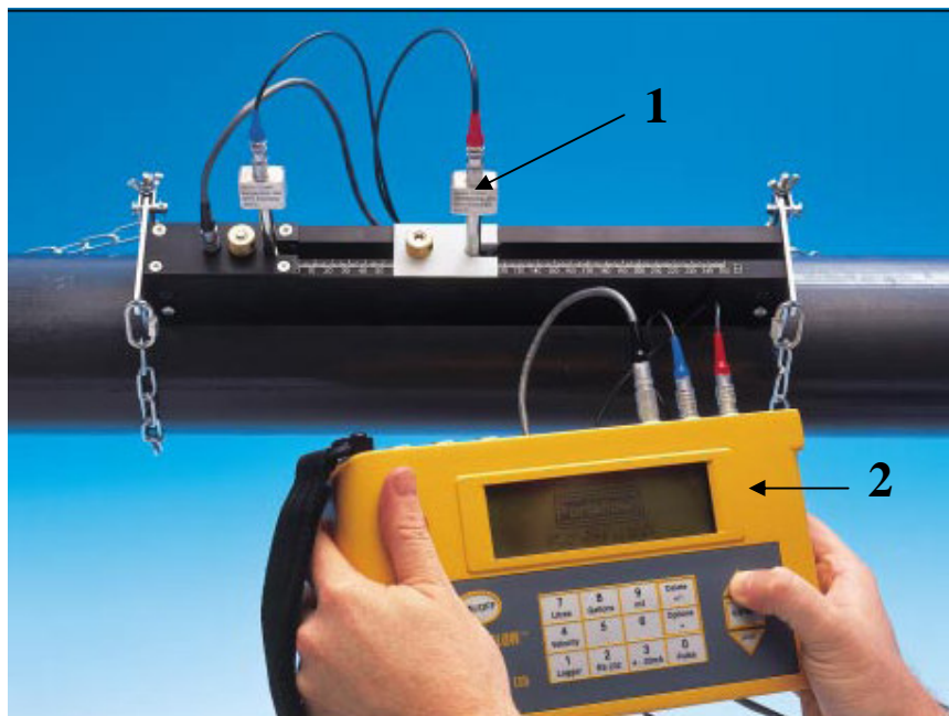
Rys. 8.3. Widok miernika przepływu: 1 – sonda pomiarowa Reflex typu A, 2 – ultradźwiękowy miernik przepływu Portaflow 300
