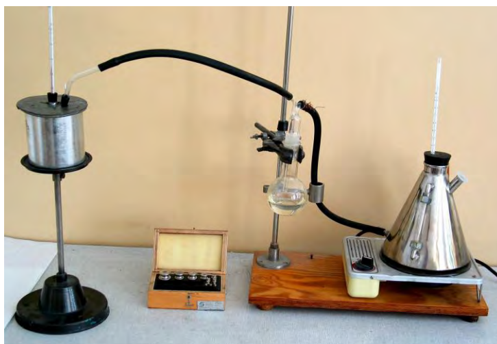
Rys. 1 Fotografia przedstawia stanowisko pomiarowe do wyznaczenia ciepła parowania wody w temperaturze wrzenia. Opis: od prawej – kociołek do podgrzewania wody stojący na kuchence
