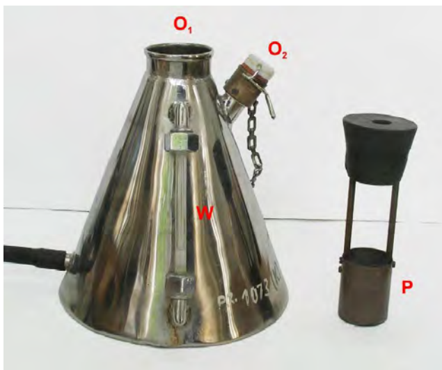
Rys. 2 Termostat oraz pojemnik na próbki P wraz z korkiem. O_1 – otwór na pojemnik P O_2 – otwór do napełniania termostatu wodą W – wskaźnik wodny
