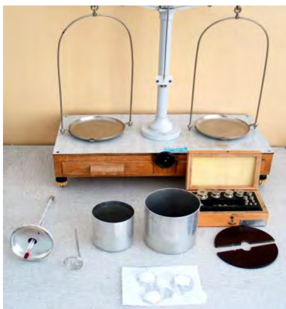
Rys. 1 Fotografia przedstawia stanowisko pomiarowe do wyznaczenia ciepła topnienia lodu. Opis: na pierwszym planie na bibule widać kawałki topniejącego lodu, dalej - kalorymetr rozłożony na
