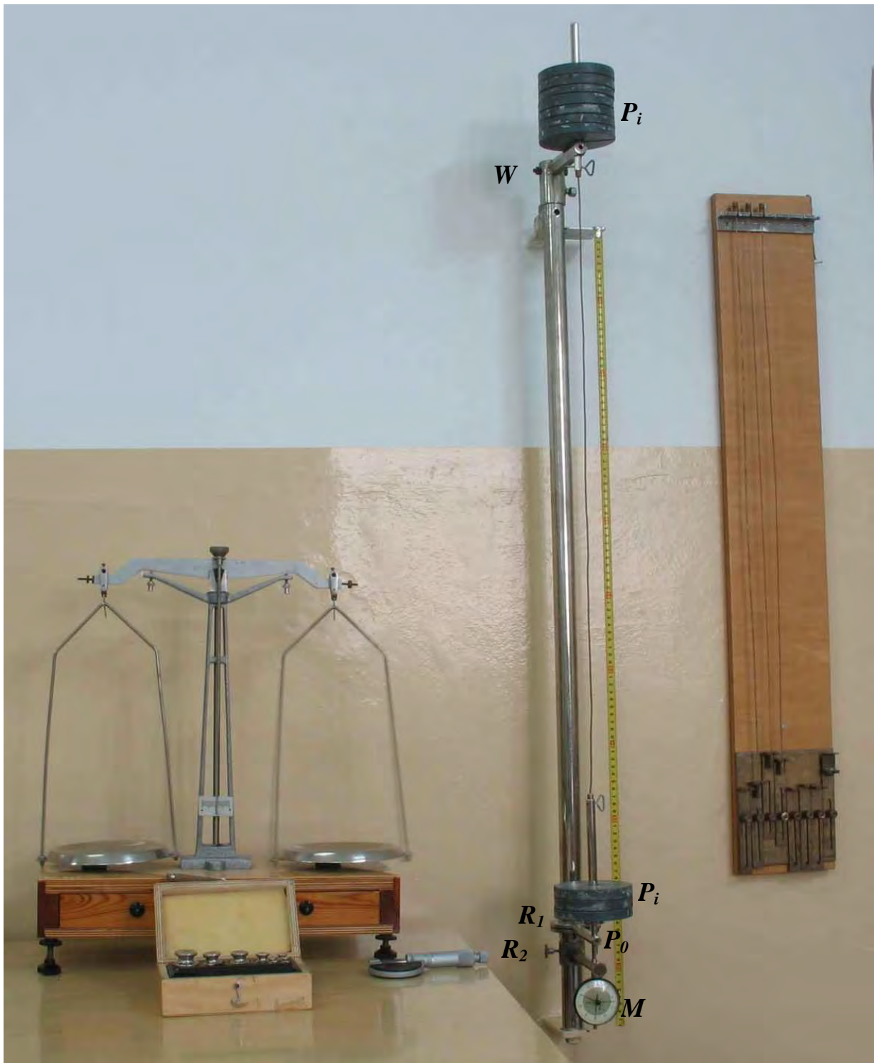
Rys. 2 Fotografia przedstawiająca stanowisko pomiarowe. Oznaczenia: W – wspornik, P_i – obciążniki, P_0 - metalowy element służący do nakładania obciążników, R_1 - metalowe ramię służące do pionowego ukierunkowania badanego pręta, M – mikromierz, R_2 - metalowe ramię służące do zamocowania mikromierza
