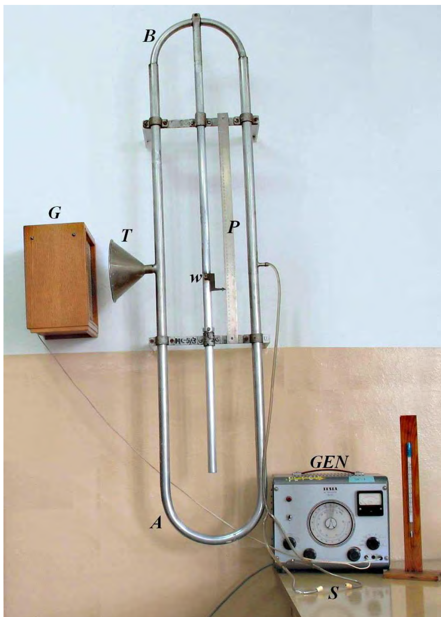
Rys. 1 Fotografia przedstawiająca stanowisko pomiarowe. Oznaczenia: A i B – rury o regulowanym położeniu względem siebie, T – tuba, w – wskaźnik, P – przymiar liniowy ze skalą, S – słuchawki, GEN – generator drgań akustycznych, G – głośnik
