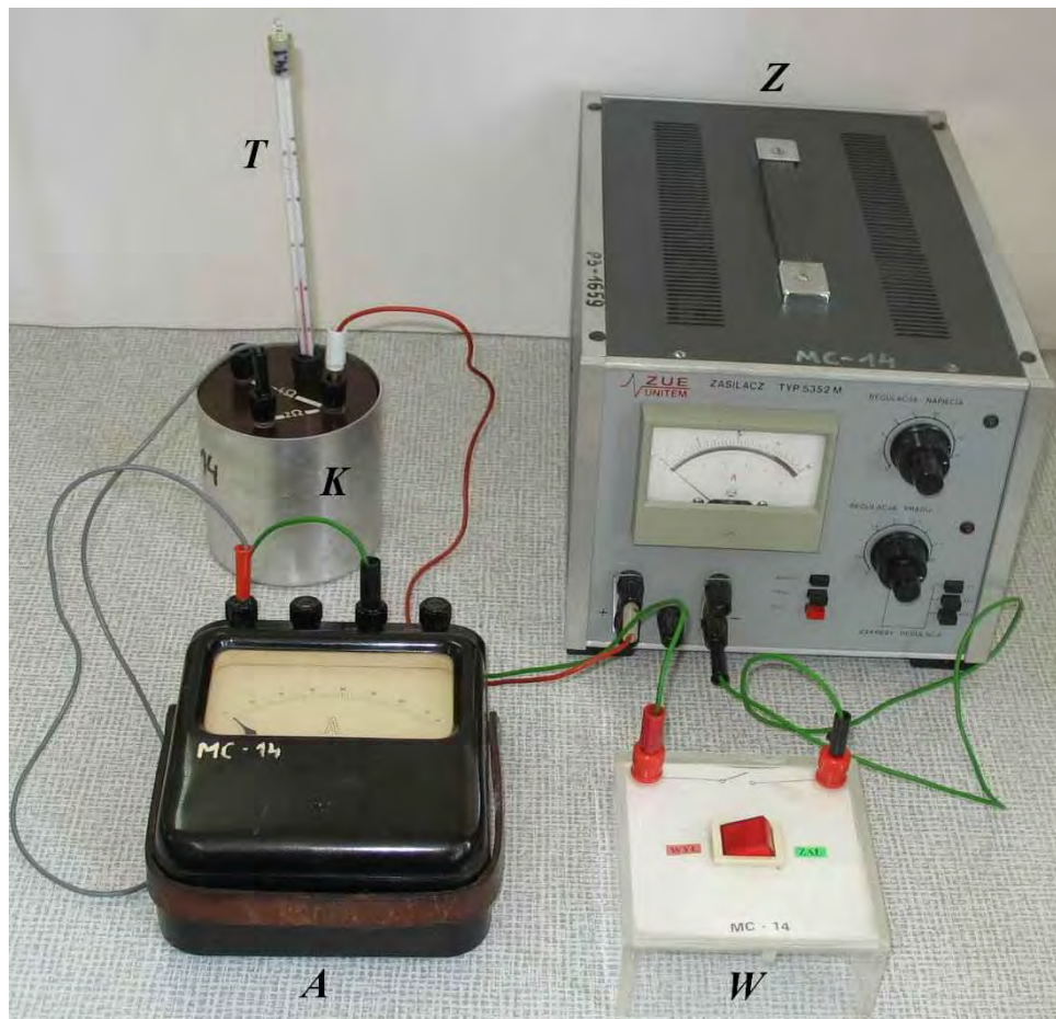
Rys. 2 Fotografia przedstawiająca stanowisko pomiarowe. Oznaczenia: Z – zasilacz, W – włącznik, A – amperomierz, K – kalorymetr, T – termometr
