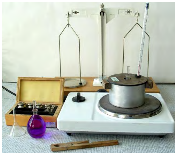
Rys. 1 Fotografia przedstawia stanowisko pomiarowe do wyznaczenia współczynnika rozszerzalności objętościowej cieczy. Opis: na pierwszym planie - drewniane szczytce do
