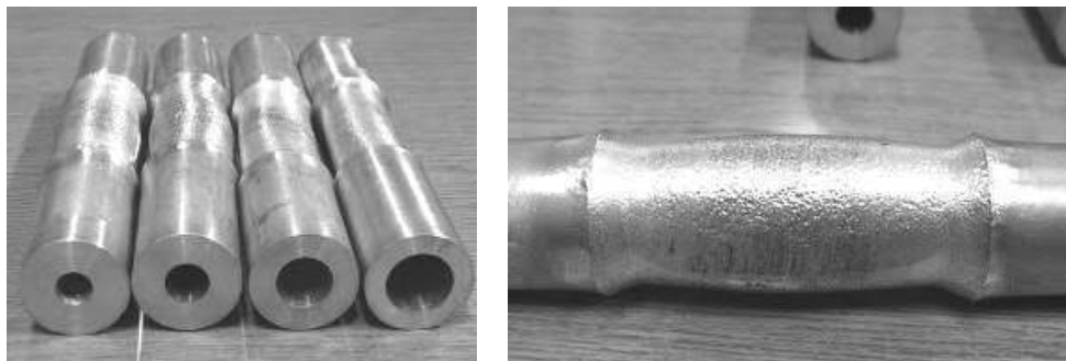
Rys. 5.12. Próbkki aluminiowe zdeformowane w trakcie procesu WPK
