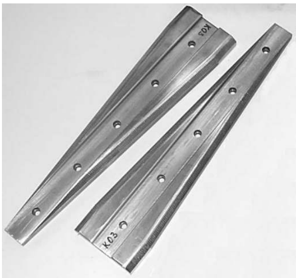
Rys. 5.8. Segmenty narzędziowe do procesu WPK zapewniające wykonanie dwóch przewężeń (rys. a) oraz trzpienie stosowane w procesie (rys. b)
