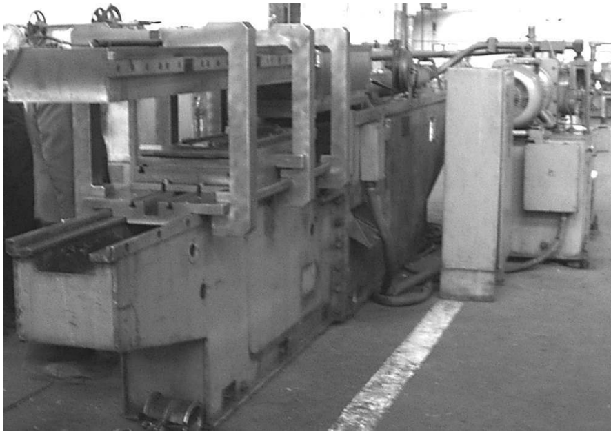
Rys. 8.4. Przemysłowa walcarka płaskoklinowa
