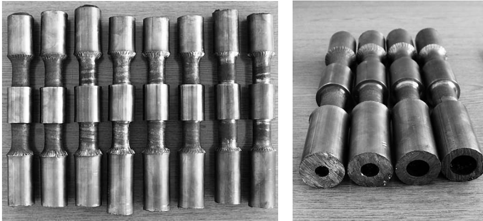
Rys. 5.15. Próbki z ołowiu Pb1 uzyskane w stabilnym procesie WPK dwóch symetrycznie rozłożonych przewężeń
