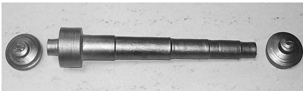
Rys 3.8. Odkuwka wałka pośredniego wraz z odpadami końcowymi odcinanymi w trakcie procesu WPK [66]
