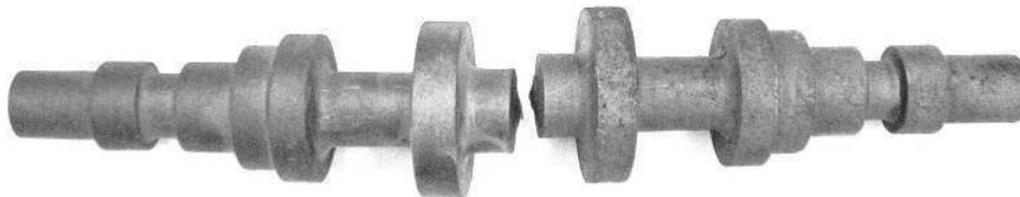
Rys 3.7. Wyroby wykonywane w układzie podwójnym (WPK) [112]
