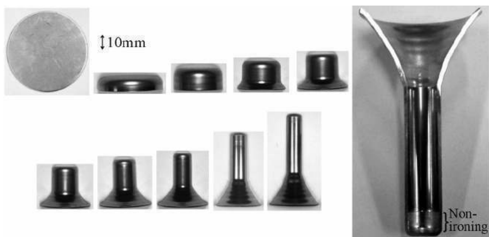
Rys. 2.5. Kolejne etapy wykonywania zaworów drążonych wytwarzanych poprzez wytlaczanie z wewnętrznym prasowaniem i kalibrowaniem trzonu [118]
