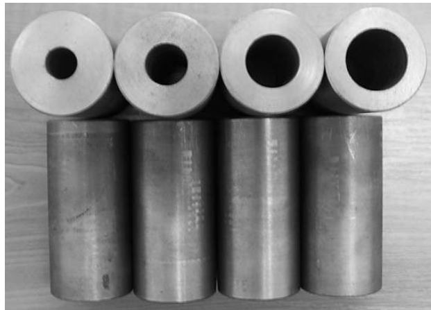
Rys. 8.5. Wsady drążone stosowane w próbach przemysłowych WPK noża obrotowego
