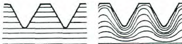
Rys. 2.11. Przebieg włókien materiału po obróbce mechanicznej (po stronie lewej) i po procesie kształtowania plastycznego (po stronie prawej) [31]
