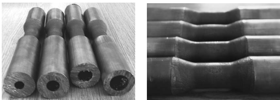
Rys. 5.9. Odwalcowane próbki z ołowiu, których kształt uznano za prawidłowy
