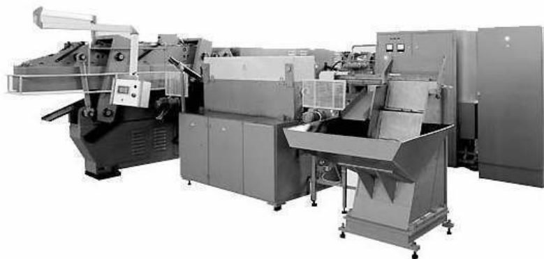
Rys. 3.4. Walcarka płaskoklinowa firmy Beltechnologia & M (Białoruś) [98]
