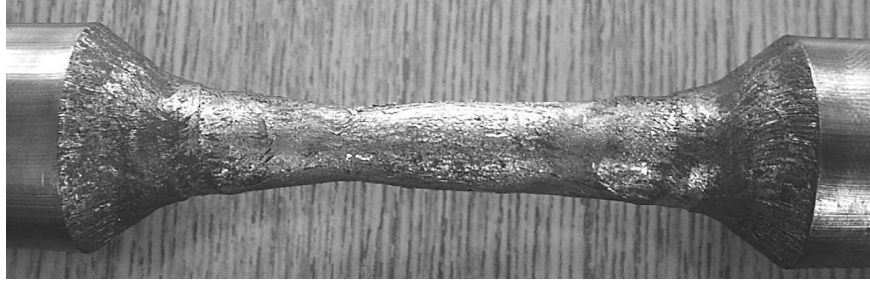
Rys. 6.18. Przewężenie centralnej części wyrobu obserwowane w procesie WPK przy \delta = 1,67 , \alpha = 30^\circ , \beta = 8^\circ , d_w = 12 mm
