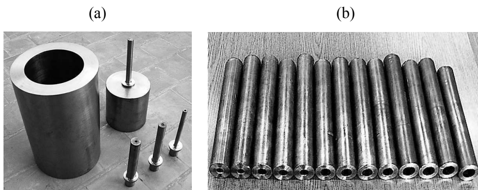
Rys. 5.6. Oprzyrządowanie do kształtowania próbek rurowych (a) oraz przykładowe próbki otrzymane w warunkach laboratoryjnych (b)
