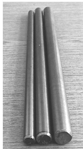
Rys. 5.8. Segmenty narzędziowe do procesu WPK zapewniające wykonanie dwóch przewężeń (rys. a) oraz trzpienie stosowane w procesie (rys. b)
