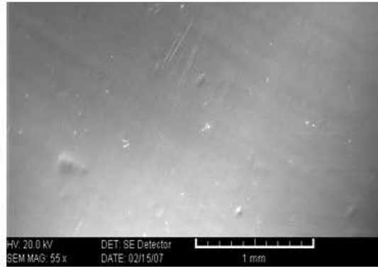
Rys. 2.17. Wygląd powierzchni kompozytu (2); g = 0,60 mm; oczyszczenie chemiczne, SEM, pow. 55
