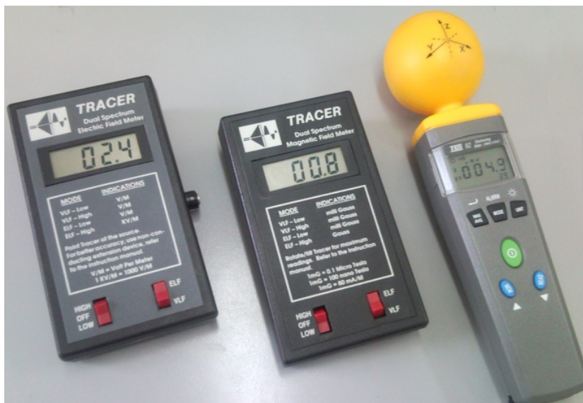
Rys. 1. Zdjęcie mierników użytych do badań, od lewej miernik Tracer EF90, Tracer MR100 oraz miernik TES -92
