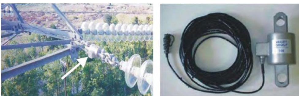
Rys.2 Metoda CAT-1 monitorowania naprężenia przewodów linii napowietrznej (właściciel materiałów firma The Valley Group) a) czujnik na linii pomiędzy izolatorem a słupem b) widok czujnika.
