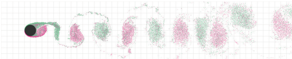
Rysunek 55. Migawka symulacji DVM A w chwili czasowej 10s
