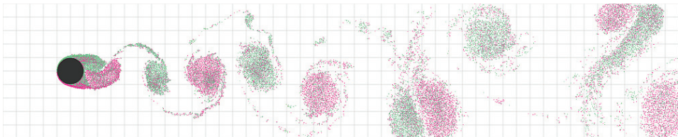
Rysunek 56. Migawka symulacji DVM A w chwili czasowej 15s
