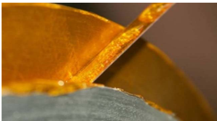
Rys. 3.18. Proces pokrywania taśmy HTS płynną żywicą epoksydową w trakcie nawijania
