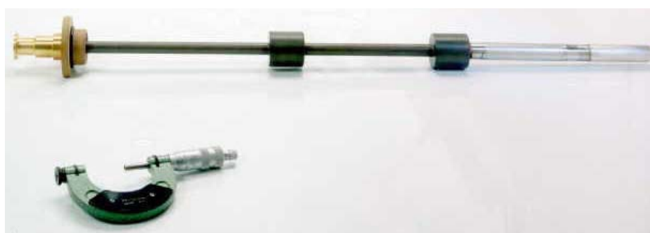
Rys. 1.26. Rozłączalny krioprzepust prądowy HTS ACCEL-Instruments o prądzie znamionowym do 400 A
