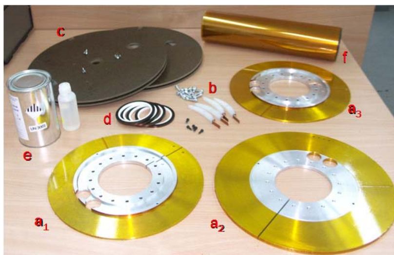
Rys. 3.14. Elementy i materiały do wykonania pojedynczej cewki nadprzewodnikowej:
