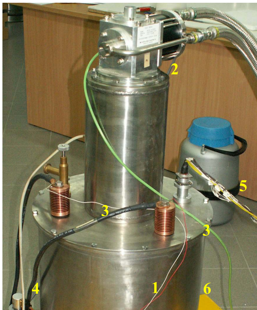
Rys. 4.5. Elektromagnes SMES-a z kriochłodziarką:
