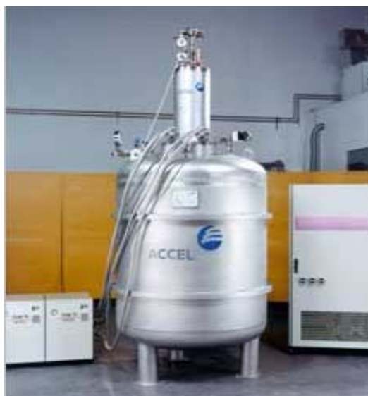
Rys. 2.1. 2 MJ SMES firmy ACCEL [14]
