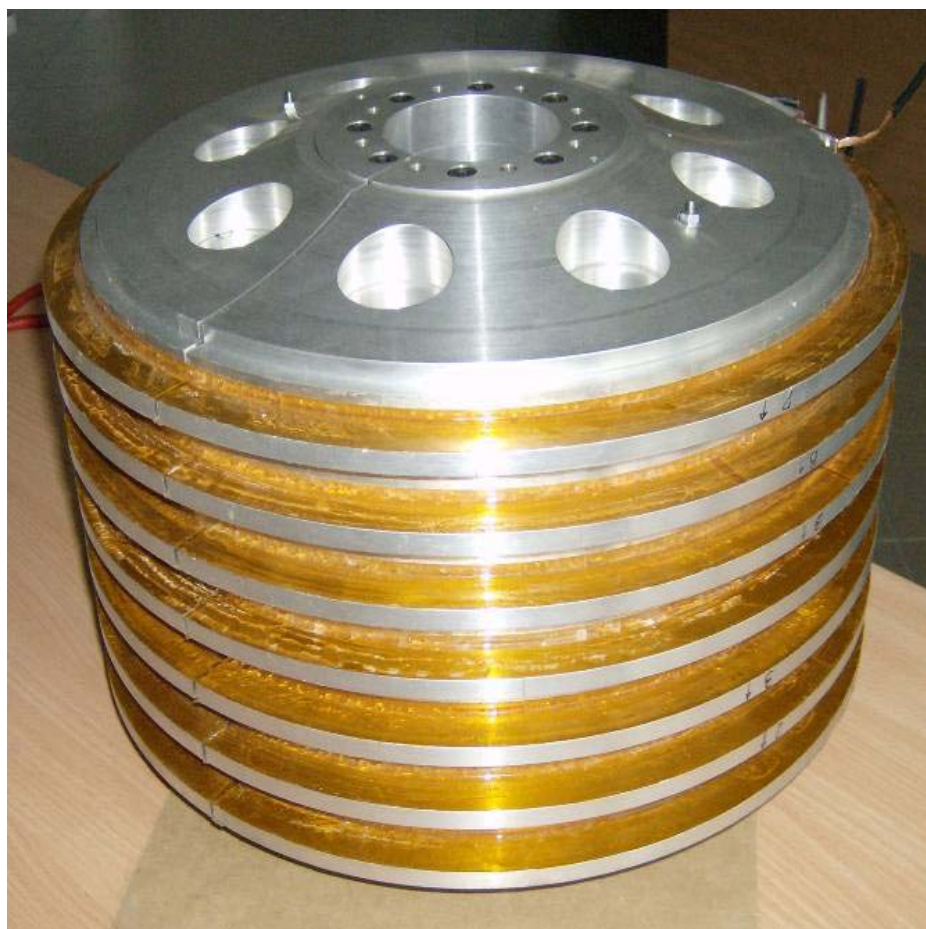
Rys. 3.19. Zmontowany elektromagnes HTS dla SMES-a
