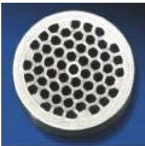
Rys. 1.12. Przekrój wiązki rur Ag ze sproszkowanym prekursorem materiału HTS umieszczonych w większej rurze Ag po wstępnym przeciągnięciu
