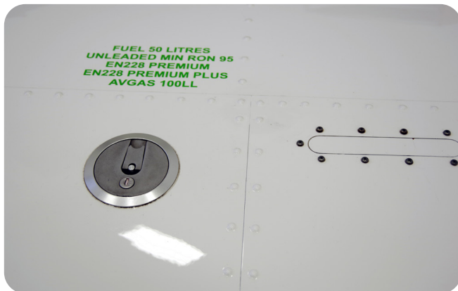
Wlew paliwa zbiornika w prawym skrzydle
