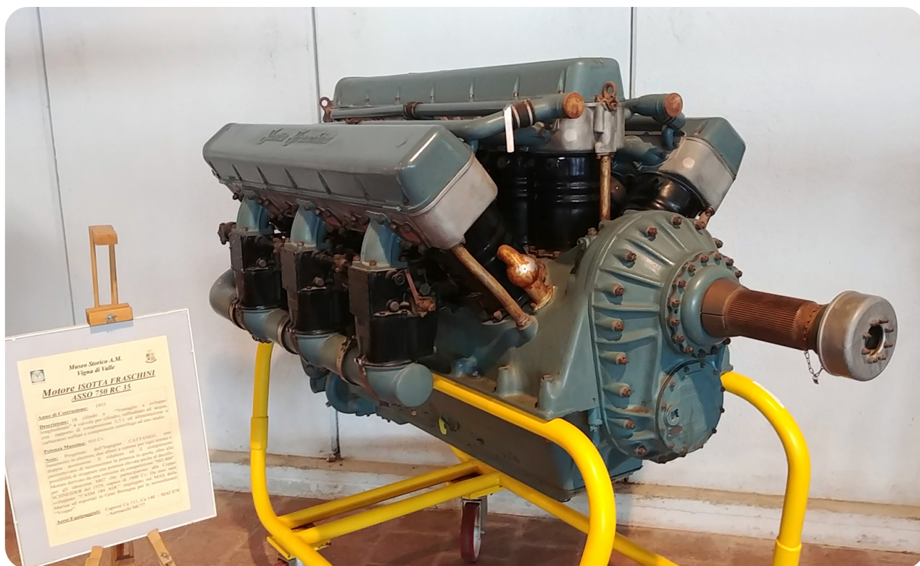
Ryc. 4. 18-cylindrowy silnik Isotta Fraschini typ Asso 750 RC. Cylindry zgrupowane są w 3 blokach rozstawionych co 30°.
