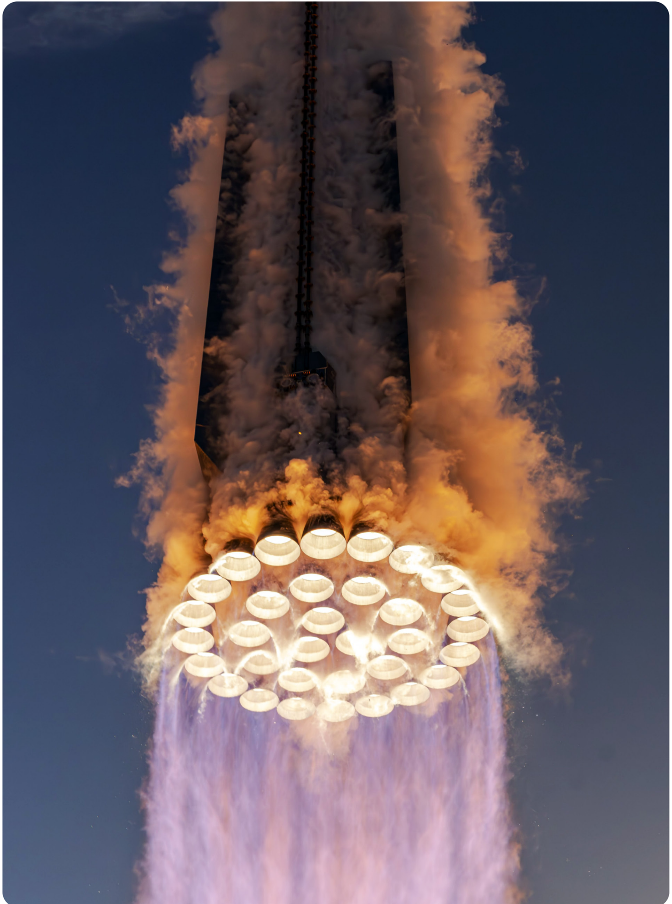
Ryc. 7. Wszystkie 33 silniki Raptor odpalone podczas startu rakiety. Źródło: [1]
