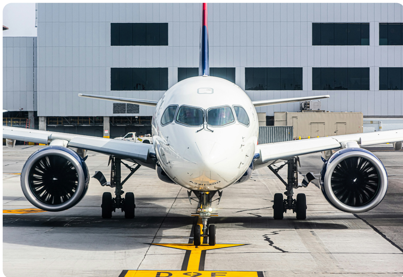
Ryc. 2. Airbus A220 z silnikami Pratt & Whitney PW1500G o współczynniku dwuprzepływowości 12:1.
