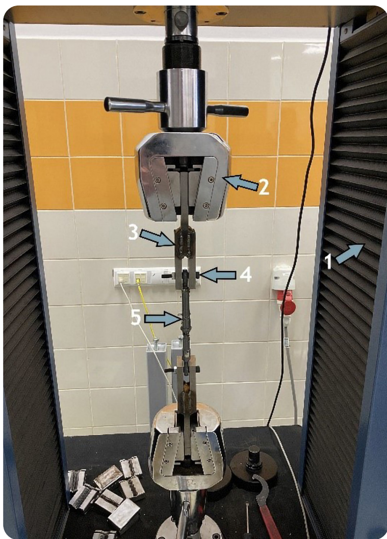
Ryc. 6. Schemat stanowiska: 1. Maszyna wytrzymałościowa, 2. Szczęki mocujące, 3. Uchwyty, 4. Śruba mocująca, 5. Popychacz.
