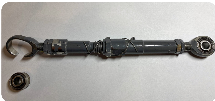
Ryc. 8. Popychacz po próbie jednoosiowego rozciągania.
