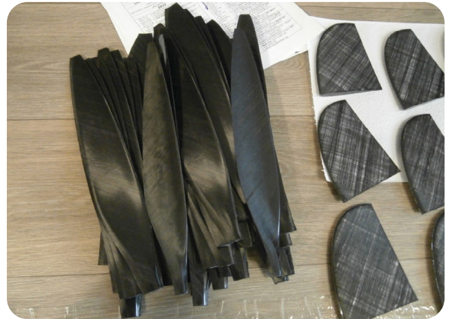
Ryc. 6. Gotowe łopatki śmigła oraz stateczniki pionowe, wykonane z kompozytu węglowego.
