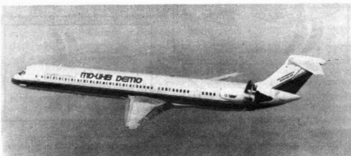
Rys. 5. Próby silnika UDF na samolocie MD-80. Fot. General Electric
