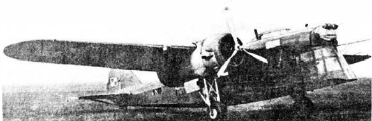
Rys. 1. Prototyp PZL-30BI Żubr po wymianie silników na Pegaz VIII i przeróbce podwozia - podczas prób
