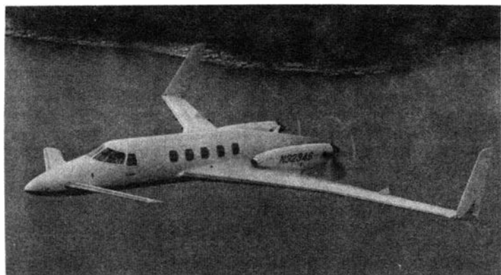
Rys. 8. Całkowicie kompozytowy samolot Starship firmy Beechcraft oblatany w lutym 1986 r.
