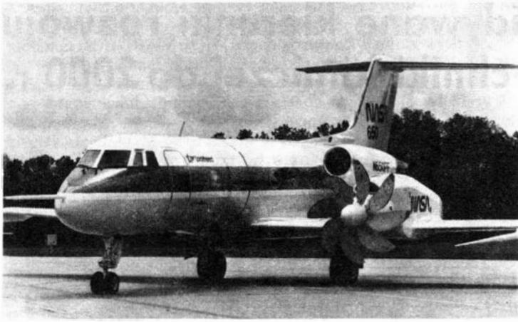
Rys. 4. Próby silnika śmigłowentylatorowego (propfan) na samolocie Gulfstream II. Fot. Lockheed
