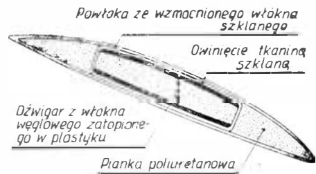
Rys. 16. Przekrój łopaty śmigła wykonanej wg techniki CFRP: widoczny dźwigar wykonany z tworzywa wzmocnionego włóknem węglowym wypełniony pianką poliuretanową; zewnętrzna powłoka łopaty z włókna szklanego
