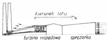
Rys. 11. Schemat układu UDF zbliżonego do opracowanego przez firmę General Electric, w którym turbina napędowa składa się z dwóch zespołów wirujących w przeciwnych stronach, napędzających pchające przeciwbieżne śmigło wentylatorowe
