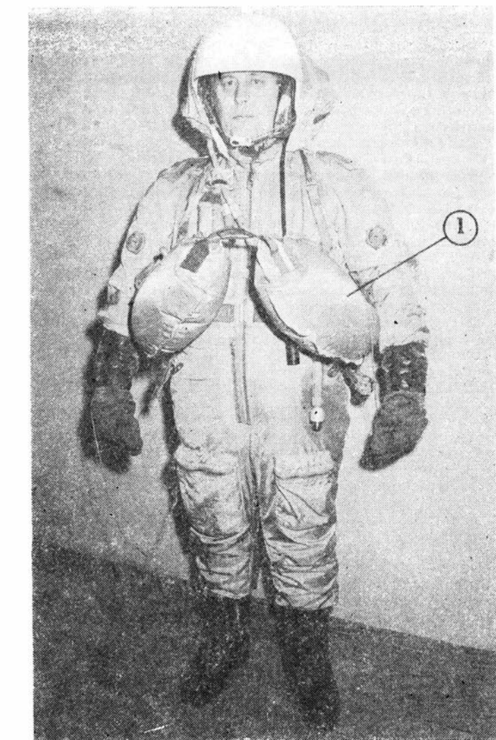
Rys. 5. Lotniczy morski ubiór ratunkowy MSK-5: 1 — nadmuchiwane komory pływaków
