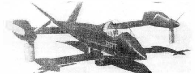
Rys. 2. Makieta samolotu Bell BAT z przekręcanymi wirnikami proponowanego zamiast lekkiego śmigłowca wojskowego. Projekt ten jest oparty na doświadczeniach uzyskanych z XV-15
