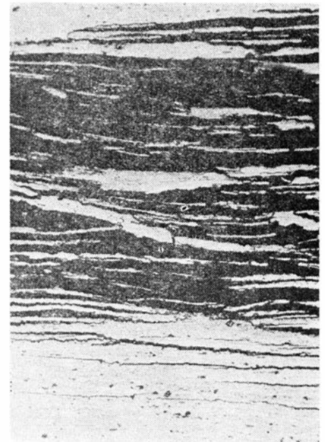
Rys. 5. Korozja warstwowa krawędzi środkowej półki; poprzeczny zgląd metalograficzny w obszarze a na rys. 4; pow. 200 × [7]
