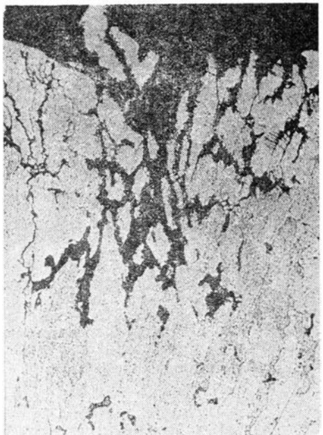
Rys. 6. Korozja międzykrystaliczna dolnej półki przedniego dźwigara skrzydła; powierzchnia pozioma, poprzeczny zgląd metalograficzny w przekroju C-C na rys. 2; pow. 200 × [7]
