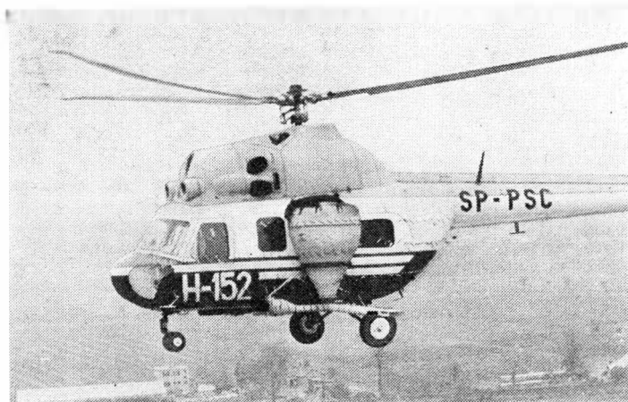
Rys. 10. Śmigłowiec Mi-2 z aparaturą dla chemikaliów stałych w locie jednosilnikowym. Fot. J. Piontek
