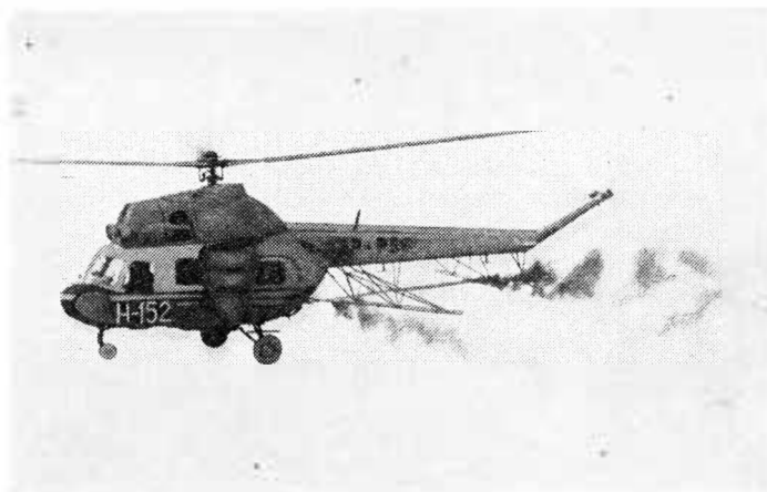
Rys. 11. Śmigłowiec Mi-2 podczas prób wizualizacji opływu przy pomocy świec dymnych przymocowanych do aparatury. Fot. W. Garbarczyk
