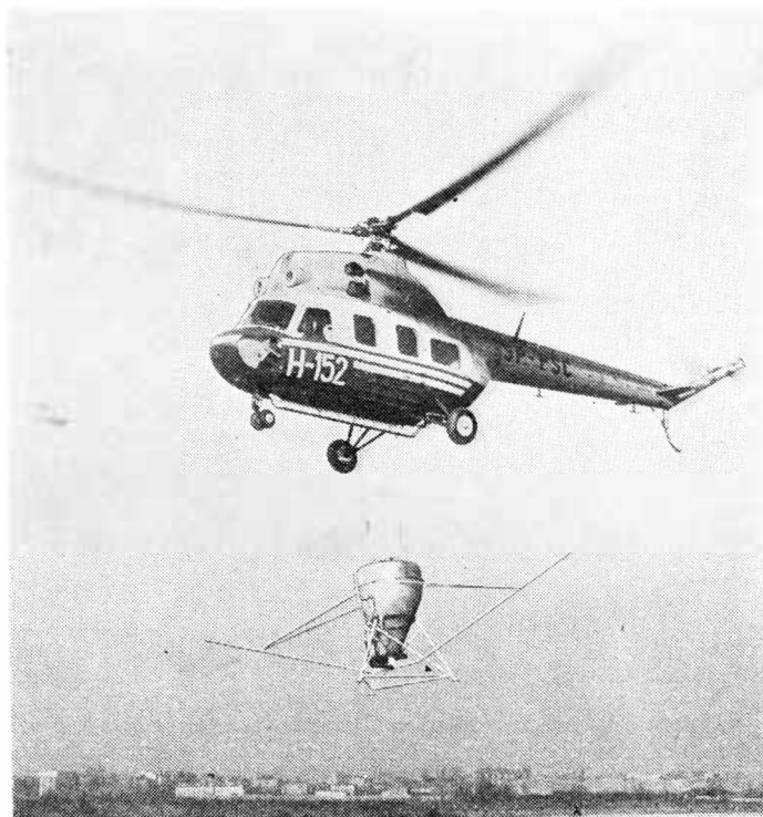
Rys. 9. Próba z eksperymentalnym urządzeniem do opryskiwania podwieszonym pod śmigłowcem Mi-2 Fot. W. Garbarczyk
