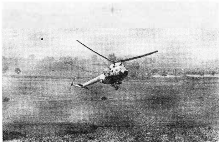
Rys. 13. Próby ergonomiczne podczas zabiegów agrolotniczych; śmigłowiec Mi-2 wykonuje typowy szybki nawrót na skraju obrabianego pola
