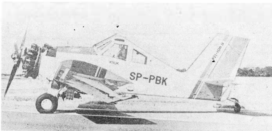
Prototyp samolotu rolniczego PZL-106 BS Kruk z silnikiem PZL ASz-62IR 736 kW (1000 KM) oblatany 8.III.1982 r. Fot. J. Kończuk
