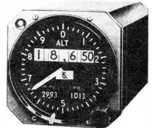
Rys. 4. Układ wskazań wysokościomierza typu Licznik — wskazówka (CP)
