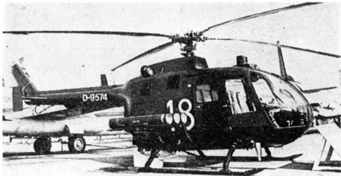
Rys. 9. Uzbrojenie przeciwczołgowe śmigłowca Bo-105 M
