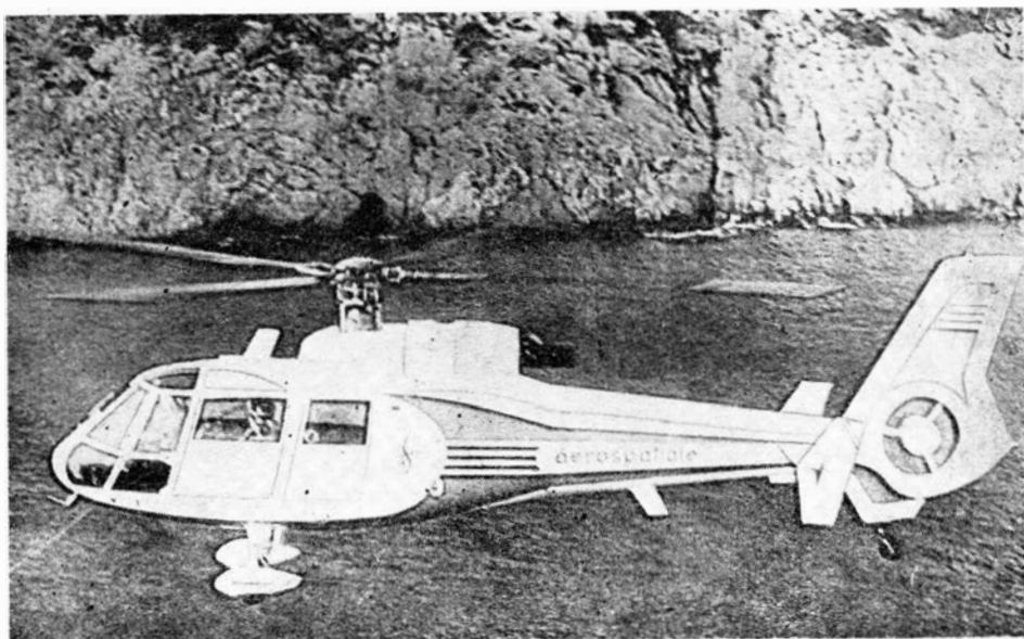
Rys. 1. SA-360 Dauphin po zmodyfikowaniu kabiny
