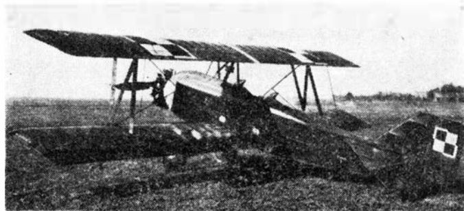
Rys. 6. Drugi prototyp z silnikiem Peterlot, oznaczony BM-4e
