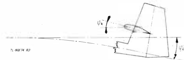
Rys. 2. Wpływ odkształcenia kadłuba na kąt natarcia usterzenia
