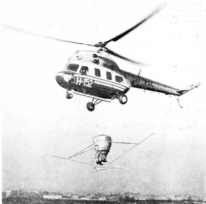
Śmigłowiec Mi-2 podczas prób z podwieszonym urządzeniem opryskującym Fot. W. Garbarczyk
