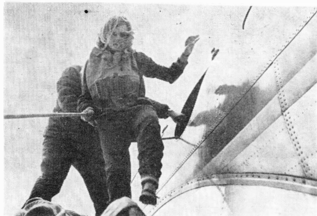
5. Il-18 — ewakuacja „po wodowaniu” wychodzenie na skrzydło w założonych, lecz nie nadmuchanych kamizelkach ratunkowych
