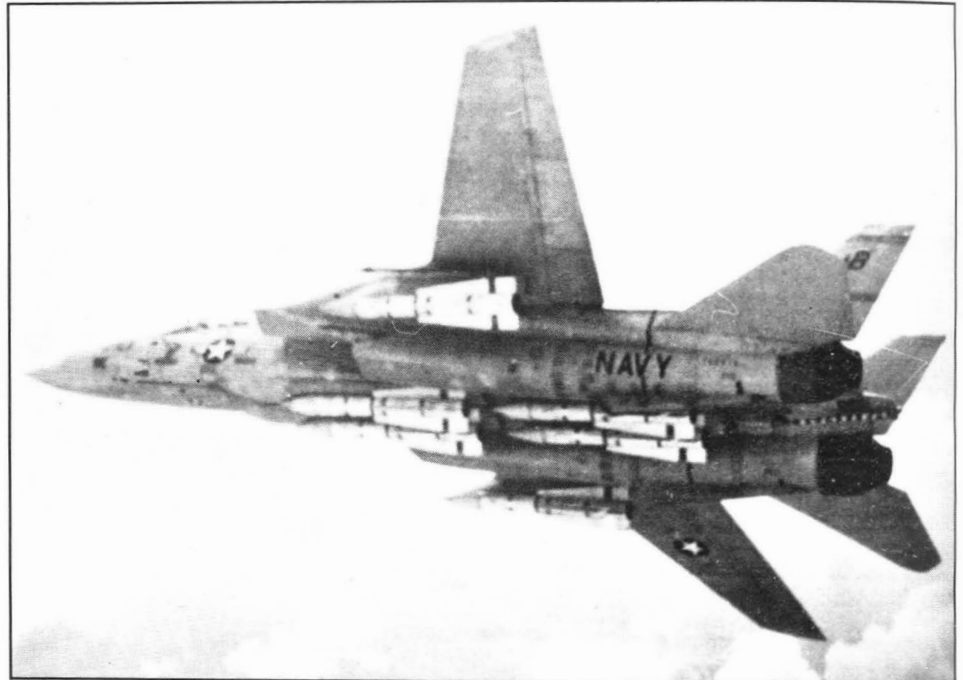
▲ F-14 z VF-32 uzbrojony w 6 pocisków rakietowych AIM-54 Phoenix ● An F-14 of VF-32 armed with 6 AIM-54 Phoenix missiles
