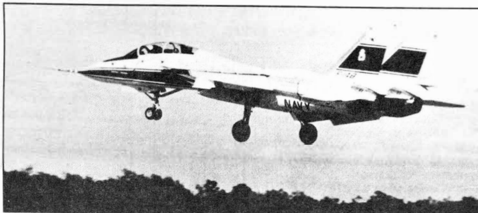
Prototyp F-14B napędzany silnikami P & W F-401 • The F-14B prototype with P & W F-401 turbofans
