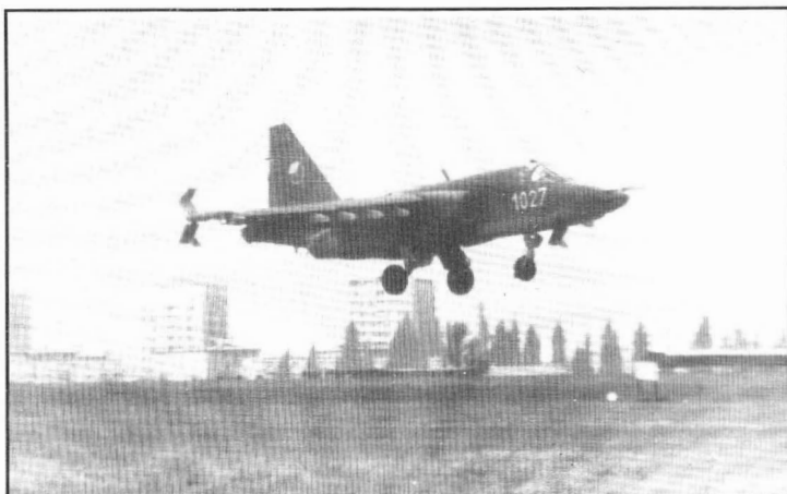
▼ Efektowne podejście do lądowania („touch-and-go”) samolotu Su-25K czechosłowackich sił powietrznych. Widoczne otwarte hamulce aerodynamiczne
