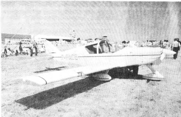
Czteromiejscowy P-230S. Konstruktor: Jean Pottier z Les Mureaux. Rozpiętość — 8,26 m, powierzchnia skrzydeł — 10,0 m 2 , długość — 6,5 m, masa własna — 390 kg, masa startowa maks. — 710 kg, pojemność zbiorników — 88 dm 3 , prędkość przelotowa (65% mocy) — 200 km/h, długotrwałość lotu — 4 h. Napęd: silnik 73,5 kW (100 KM)
