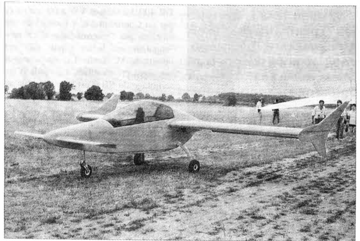
Dwumiejscowy RJ 03 Ibis. Konstruktor: Roger Junqua z Bordeaux. Rozpiętość — 6,0 m, długość 4,6 m, masa własna — 225 kg, masa startowa maks. — 420 kg, pojemność zbiorników — 60 dm 3 , prędkość maks. — 230 km/h, prędkość przelotowa (75% mocy) — 210 km/h, prędkość lądowania — 95 km/h, zasięg — 900 km. Napęd: silnik VW 1800 cm 3
