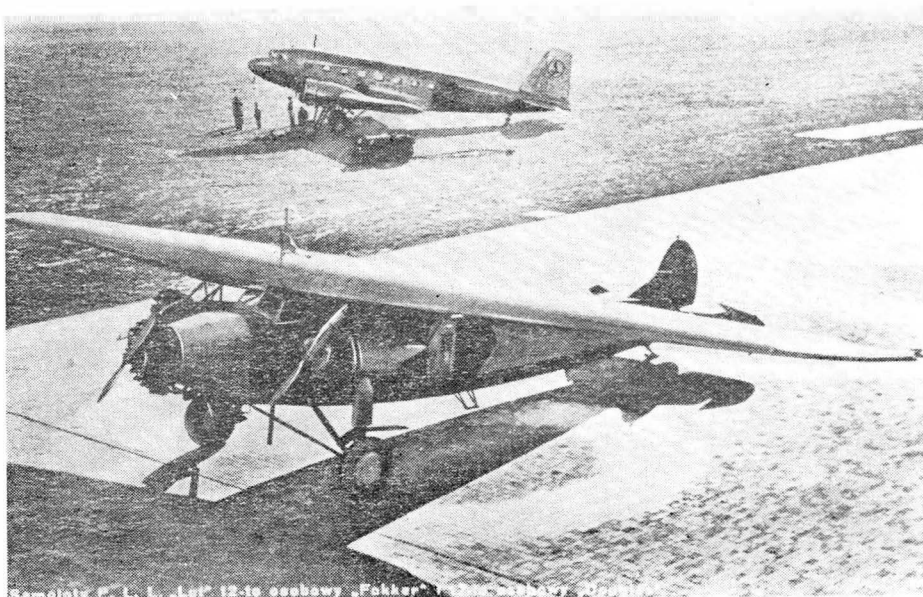
3. 12-osobowy samolot Fokker F-VII i 17-osobowy Douglas DC-2 w służbie PLL „LOT”
