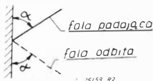
Rys. 2. Odbicie fali grawitacyjnej od ścianki
