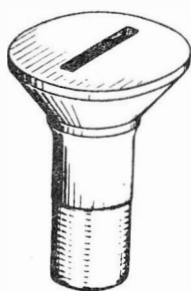
Rys. 1. Połączenie powłok zbiornika integralnego za pomocą wkrętów o specjalnej konstrukcji z „ostrą krawędzią” u nasady łba
