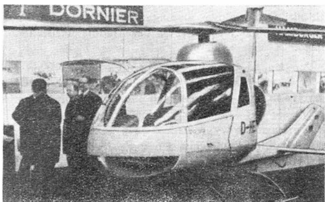
18. Lekki śmigłowiec z ciśnieniowym napędem wirnika Dornier Do 132
