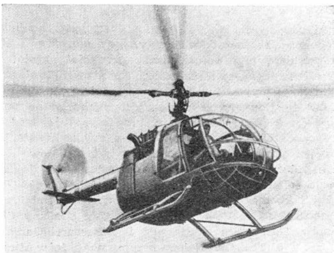
17. Lekki śmigłowiec ze sztywnym wirnikiem Bölkow BO 105
