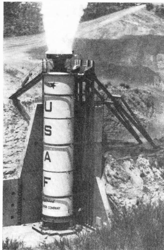
4. Próba na stoisku silnika raketowego o średnicy 4 m, na stały materiał pędny
