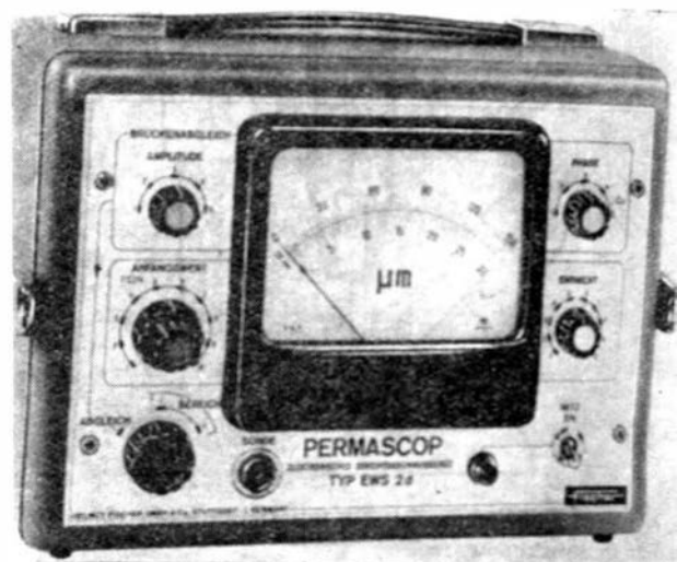
3. Warstwowierz na prądy wirowe Permascop produkcji Instytutu Fischera, NRF, do pomiarów grubości powłok tlenkowych
