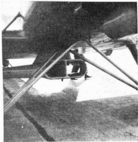
Rozsypywacz do chemikaliów sypkich samolotu rolniczego AN-2M
