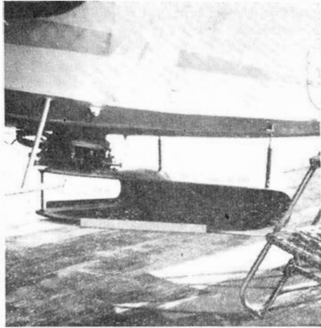
Rozsypywacz do chemikaliów sypkich samolotu GAWRON
