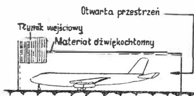
Rys. 15. Jeden z projektów koncepcyjnych hangaru-boksu dla portu lotniczego Hamburg
