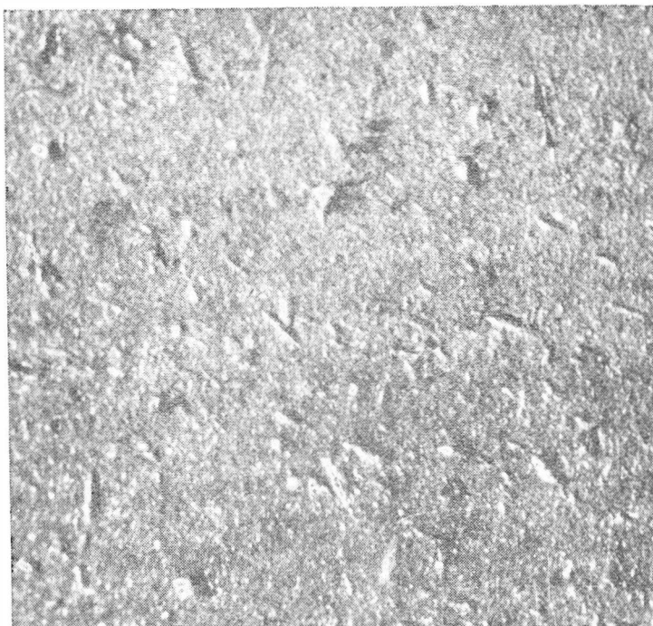
Rys. 15. Wygląd powierzchni obrabianej strumieniowo-ściernie ziarnem \text{Al}_2\text{O}_3 Z60. Widoczne pojedyncze ziarna tkwiące w materiale obrabianym (25 x)
