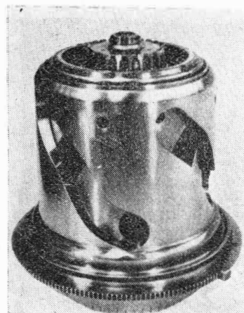
Rys. 21. Zespół cylindrów z krzywkami oraz ryglami hydraulicznymi i mechanicznymi
