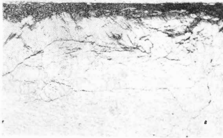
Rys. 6. Mikrostruktura stali stabilizowanej po azotacji. Od góry widoczna „czarna warstewka”, a pod nią struktura martenzytyczna. Pow. 1000 ×
