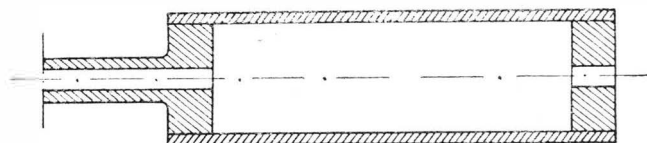
Rys. 5. Rurka Pitota stosowana tylko przy prędkościach naddźwiękowych
