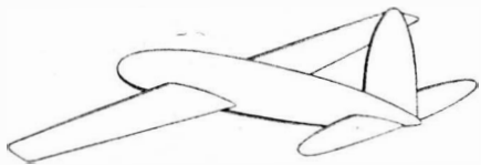
Rys. 1 Kombinacja 314: usterzenia eliptyczne.
