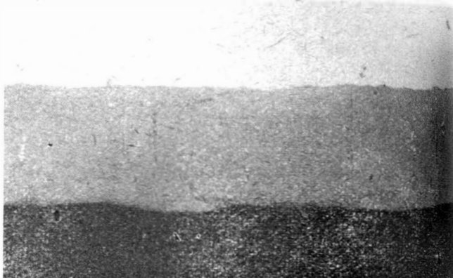
Rys. 1. Mikrostruktura warstwy anodowanej (200 X nietraw)
