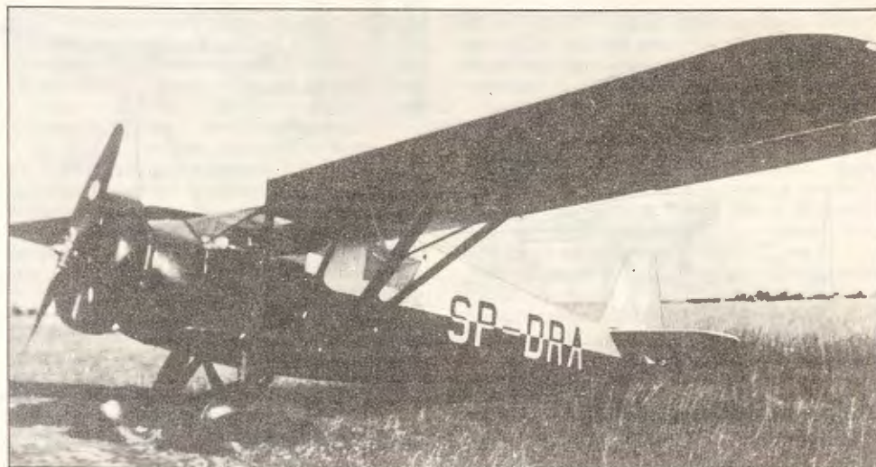
RWD-9W SP-DRB (napędzany silnikiem Walter Bora), w początkowej wersji z płaskimi szybami wiatrochronu
