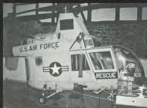
▲ Dwa wirniki, dwie belki ogonowe, cztery stateczniki – sporo jak na jeden niewielki śmigłowiec. Kaman HH-43B Huskie był do niedawna jedynym przedstawicielem układu konstrukcyjnego o przecinających się płaszczyznach wirników; obecnie wytwórnia ta prowadzi próby nowego śmigłowca o takim układzie
