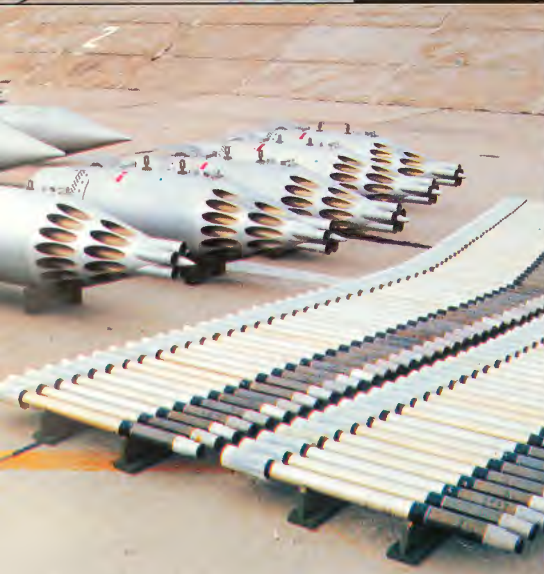
▲ Su-22M4 i jego uzbrojenie ◀ Dwudziestolufowe wyrzutnie B-8 z raketami S-8 kal. 80 mm ▶ Rakieta powietrze-ziemia H-25ML naprowadzana laserowo; masa — 300 kg, długość — 4255 mm, zasięg — 10000 m ▼ Wyrzutnie UB-32, a przed nimi rakiety niekierowane S-5
