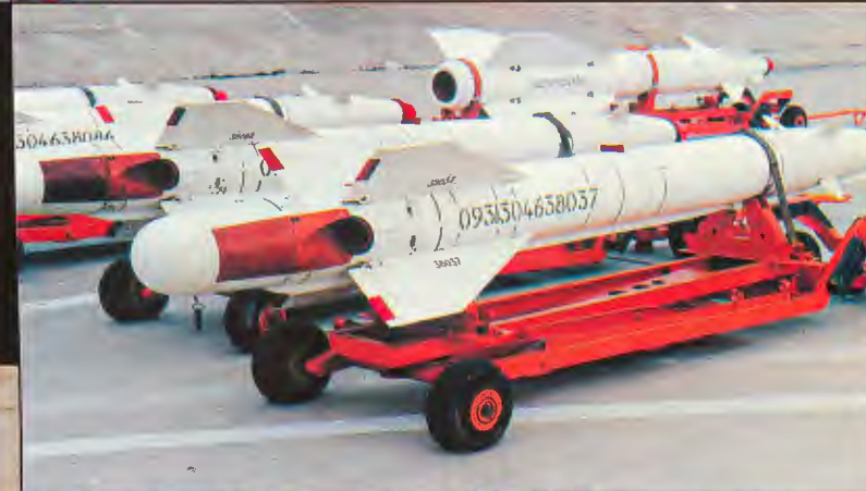
▲ Su-22M4 i jego uzbrojenie ◀ Dwudziestolufowe wyrzutnie B-8 z raketami S-8 kal. 80 mm ▶ Rakieta powietrze-ziemia H-25ML naprowadzana laserowo; masa — 300 kg, długość — 4255 mm, zasięg — 10000 m ▼ Wyrzutnie UB-32, a przed nimi rakiety niekierowane S-5
