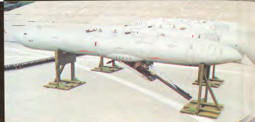
▲ Zasobniki kasetowe ZR-8 produkcji polskiej z pakietami do bomb kulkowych (przed nimi) ▼ Zasobnik SPPU-22-01 z działkami, których lufy (na zdjęciu) są wychylone do dołu
