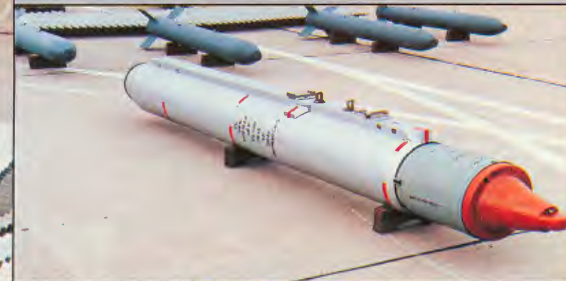
▲ Ciężka rakietą niekierowana S-250F odpalana z pojedynczych, jednorazowych wyrzutni 0-25 ▶ Niekierowane rakiety S-24
