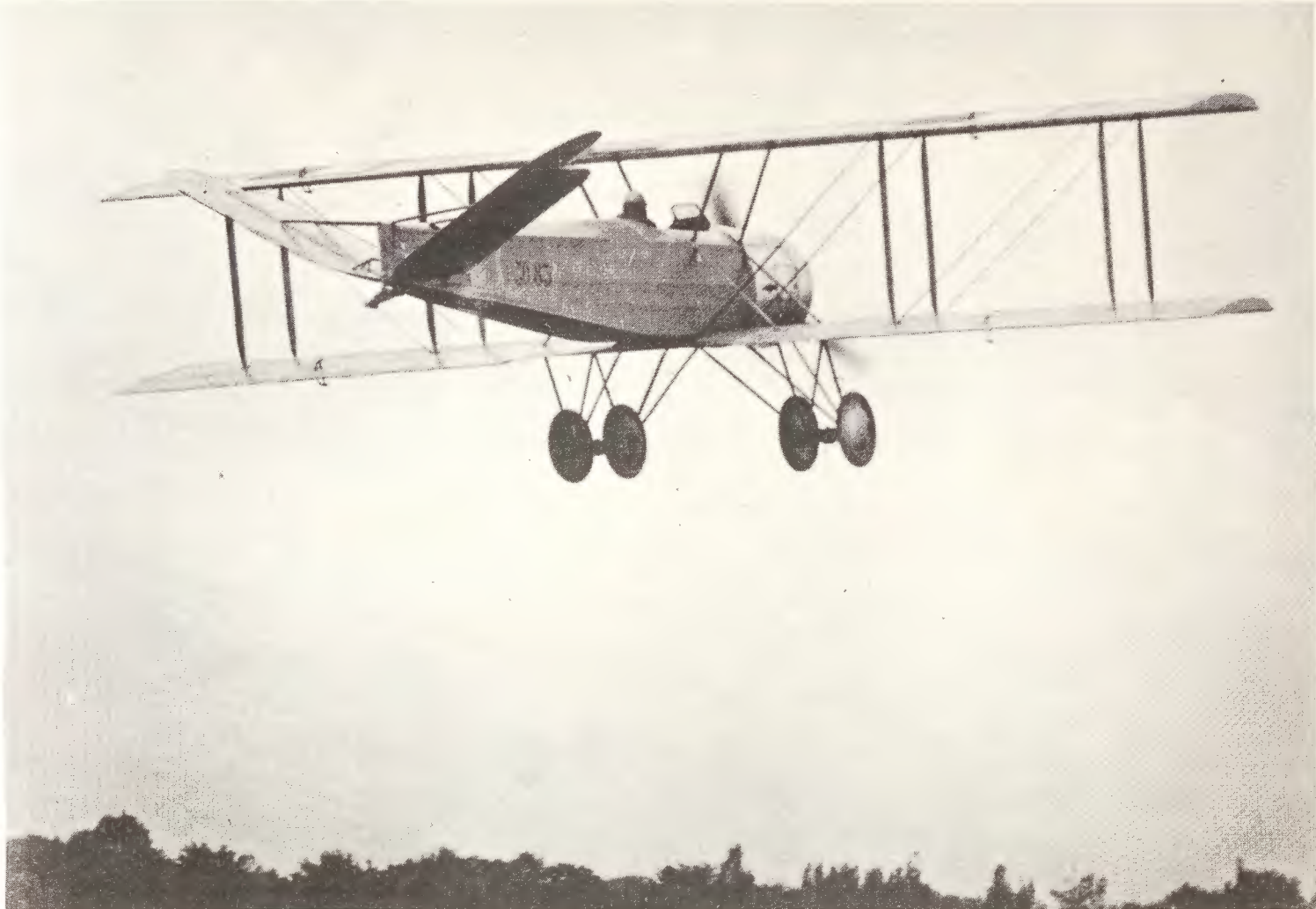
Pierwszy w świecie samolot z usterzeniem w układzie V pomysłu inż. Jerzego Rudlickiego — Hanriot H-28 nr 30.83, wyposażony w to usterzenie w Lublinie, w 1931 r.
