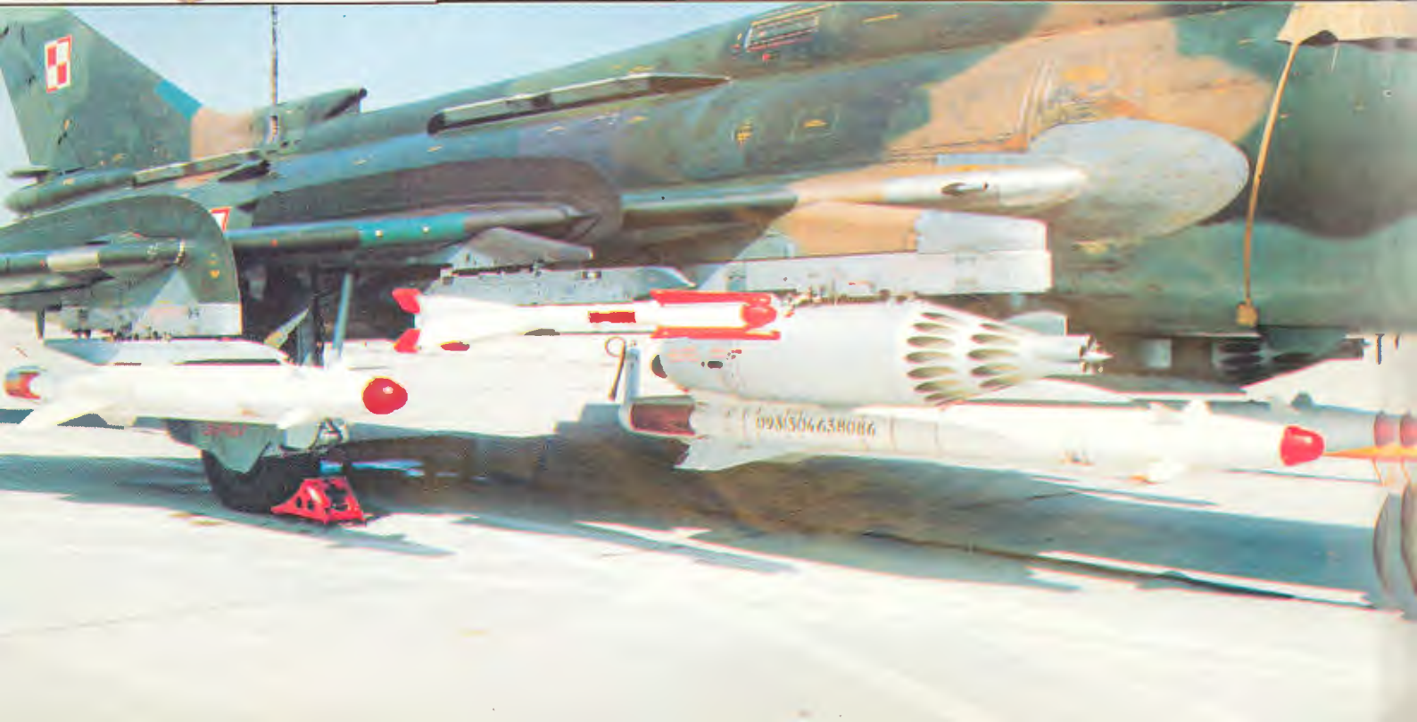
◀ Bomba OFAB-100-120 ▼ Su-22M4, pod którego prawym skrzydłem i kadłubem podwieszane są rakiety powietrze-zie-mia H-25ML, rakieta powietrze-powietrze R-60 oraz wyrzutnia UB-32 z rakieta-mi S-5
