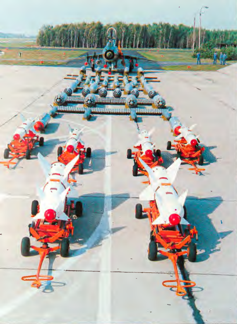
▲ Su-22M4 i jego uzbrojenie ◀ Dwudziestolufowe wyrzutnie B-8 z raketami S-8 kal. 80 mm ▶ Rakieta powietrze-ziemia H-25ML naprowadzana laserowo; masa — 300 kg, długość — 4255 mm, zasięg — 10000 m ▼ Wyrzutnie UB-32, a przed nimi rakiety niekierowane S-5
