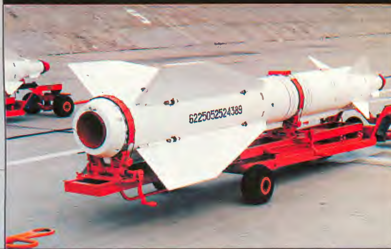
▲ Rakiety H-25MP do zwalczania naziemnych stacji radiolokacyjnych ▼ Ciężkie rakiety H-29L kierowane laserowo
