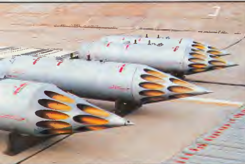
▲ Su-22M4 i jego uzbrojenie ◀ Dwudziestolufowe wyrzutnie B-8 z raketami S-8 kal. 80 mm ▶ Rakieta powietrze-ziemia H-25ML naprowadzana laserowo; masa — 300 kg, długość — 4255 mm, zasięg — 10000 m ▼ Wyrzutnie UB-32, a przed nimi rakiety niekierowane S-5
