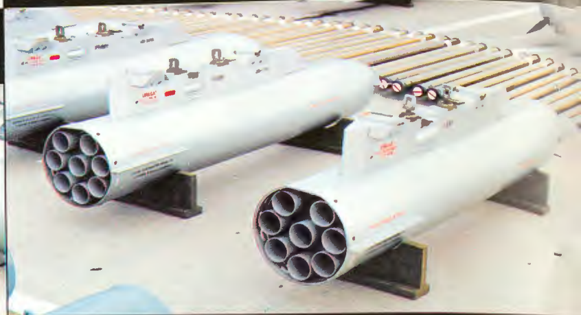
▲ Zasobniki kasetowe ZR-8 produkcji polskiej z pakietami do bomb kulkowych (przed nimi) ▼ Zasobnik SPPU-22-01 z działkami, których lufy (na zdjęciu) są wychylone do dołu
