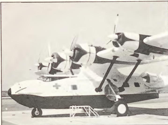
Nie było czterosilnikowej Cataliny? No to teraz już jest – sanitarny „The Wandering Albatross” napędzany dodatkowo dwoma rzędownymi, płaskimi silnikami tłokowymi; zwracają też uwagę przebudowane gondole obserwacyjne po bokach tylnej części kadłuba (widoczna lewa) Zdjęcie: Marian Krzyżan
