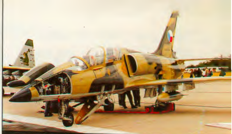
▲ L-39MS z 1. Szkołnego Pulku Lotniczego w Prešov, demonstruje opuszczoną lawetę działka i otwarte osłony przedziału awioniki
