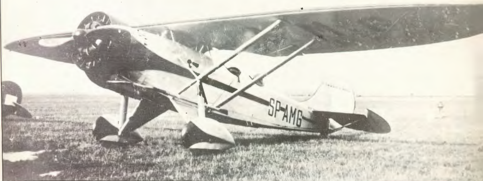
Cywilny dyspozycyjny Lublin R-XIIID nr 56-127 SP-AMG, malowany na srebrno-czerwono (1934 r.). Samolot ma owiewki kół, tylną kabinę pasażerską i zmieniony statecznik pionowy
