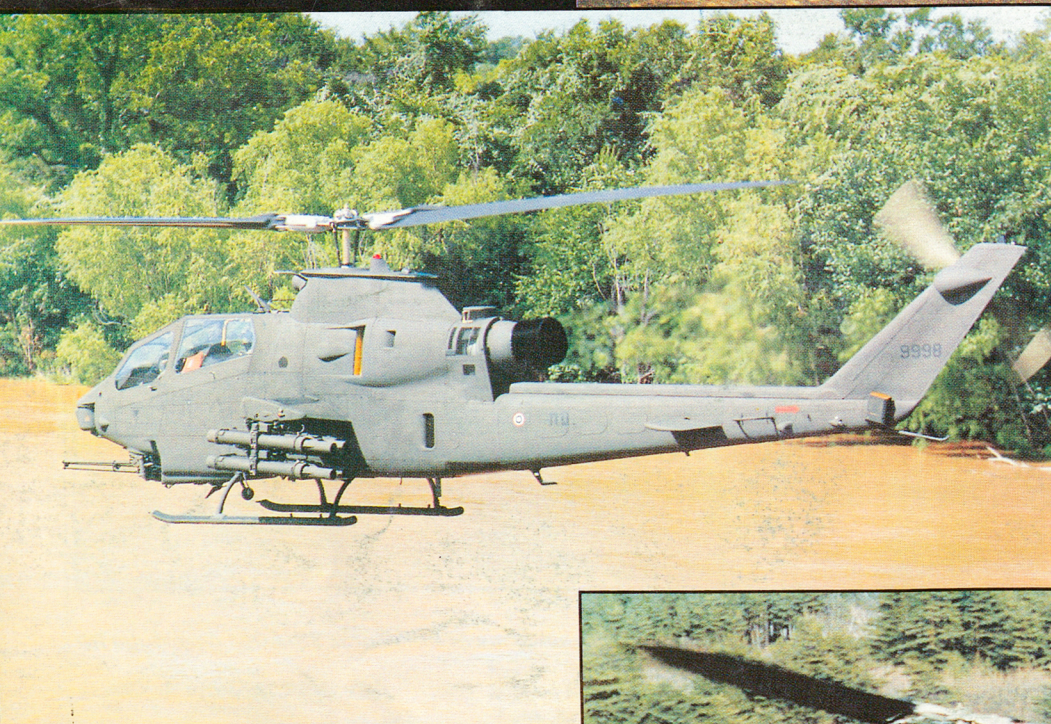
▲ AH-1F Tajlandii – wyraźnie widoczna wyrzutnia flar termicznych umieszczona na końcu belki ogonowej
