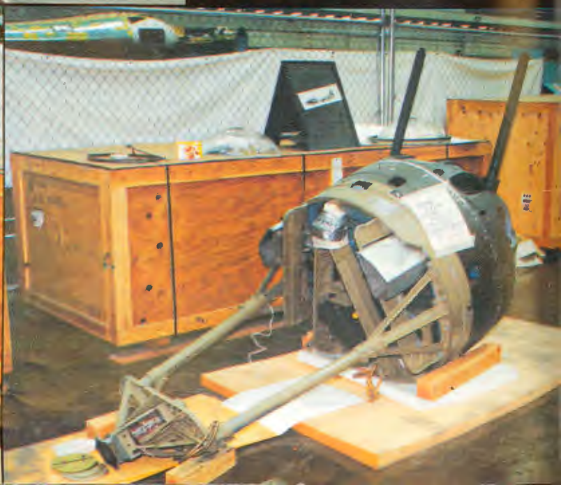
▼, ▼ ◀ Wymontowana i położona grzbietowa wieżyczka
