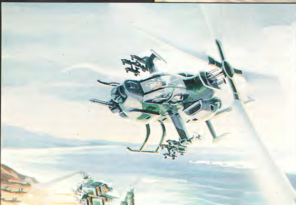
◀ AH-1 Viper (wizja artysty) – zwracają uwagę wyrzutnie rakiet powietrze-powietrze umieszczone na górnych powierzchniach zewnętrznych belek podwieszni
