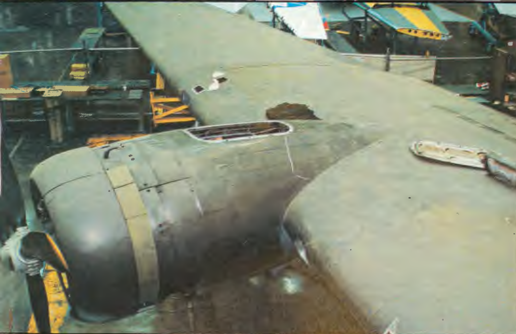
▼, ▼ ◀ Wymontowana i położona grzbietowa wieżyczka
