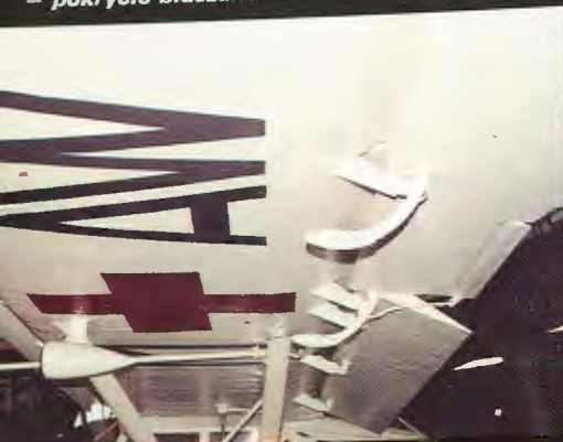
▼ Dolna powierzchnia lewego skrzydła – pokrycie blaszane
