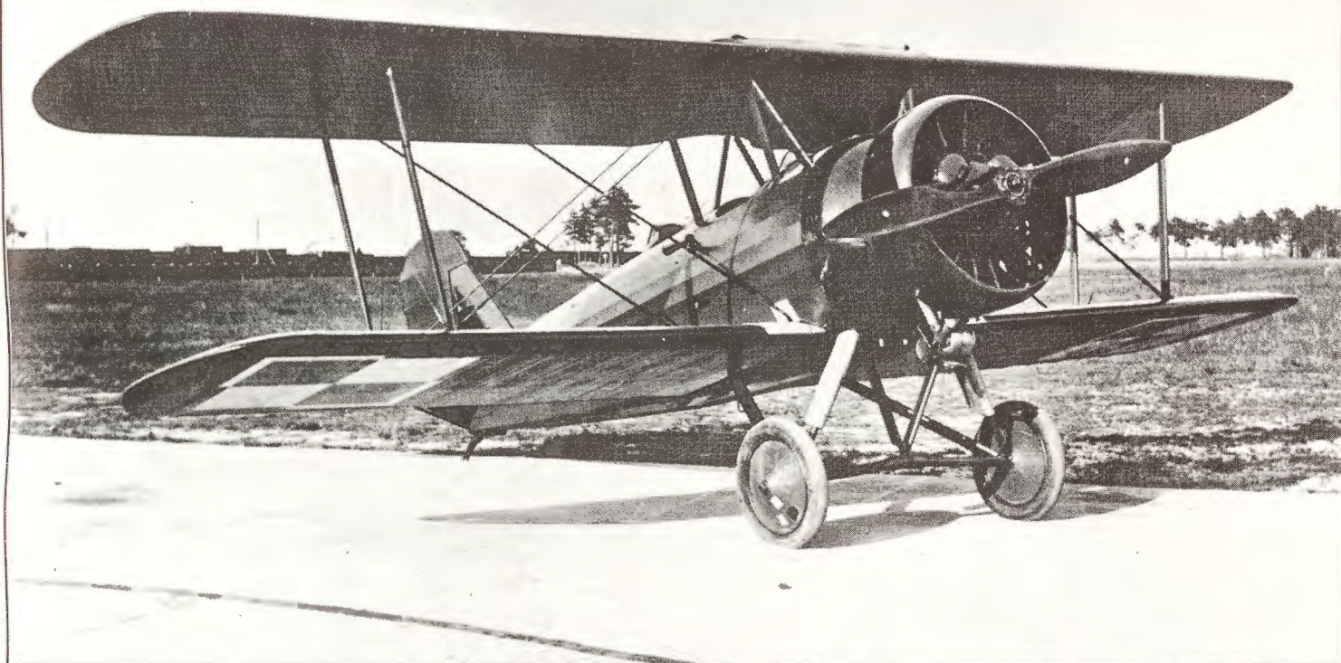
▲ Pierwszy prototyp samolotu szkolno-treningowego PWS-12 w 1930 r. po zaokrągleniu końcówek skrzydeł i zmianie osłony silnika
