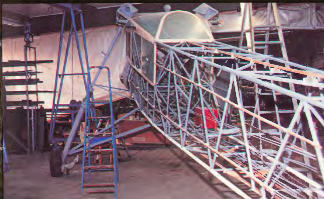
▼ Kratownica kadłuba podczas remontu
