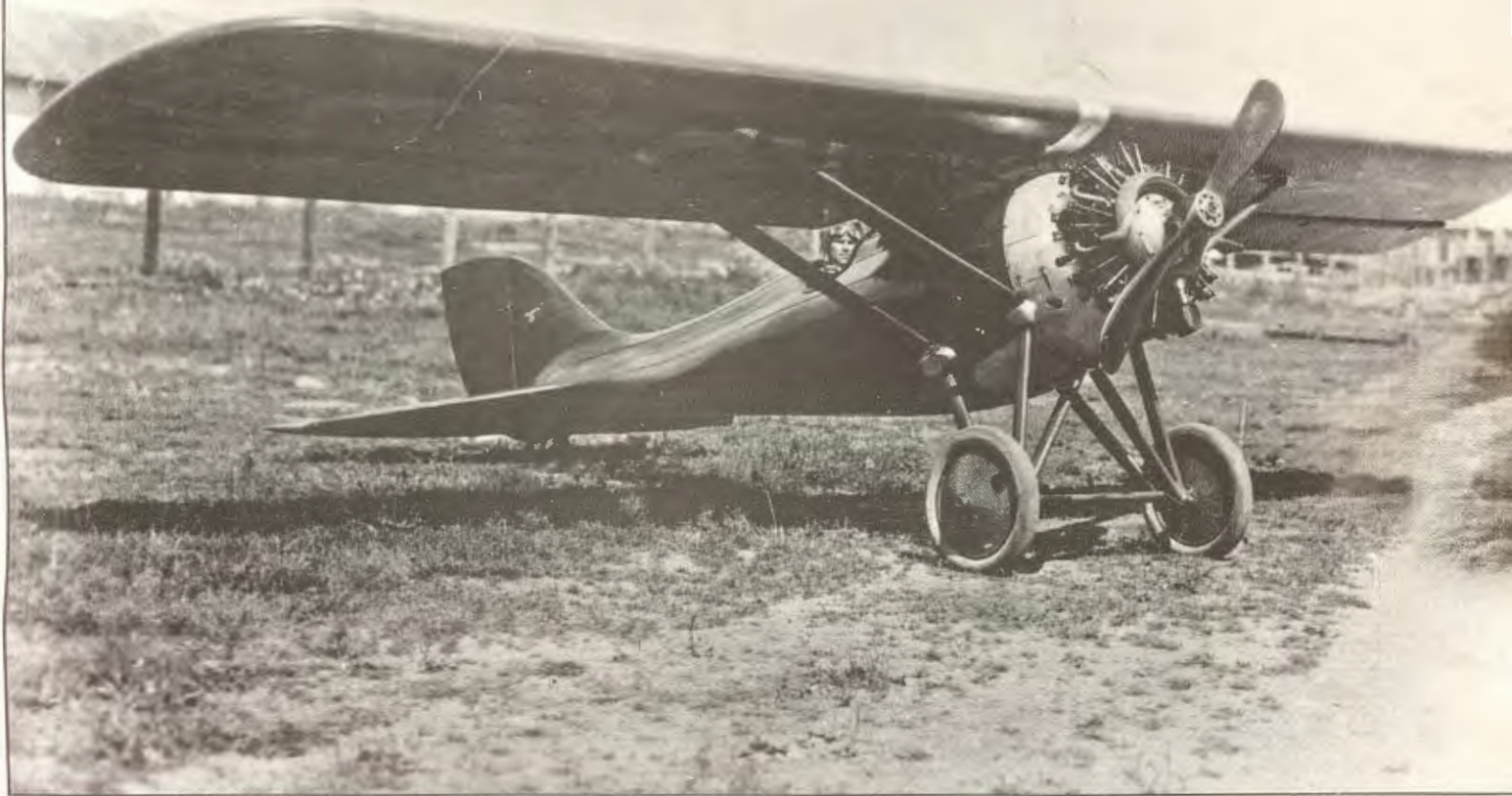
Samolot doświadczalny Sp I z silnikiem Salmson AC 9, inż. Piotra Tulacza (studium samolotu szkolnego) skonstruowany w Wielkopolskiej Wytwórni „Samolot” w 1926 r. W samolocie tym zwraca uwagę pokrycie z listew sklejkowych (2 mm) oraz rozwiązanie przejścia kadłub-usterzenie – wpływ doświadczeń skutniczych?
