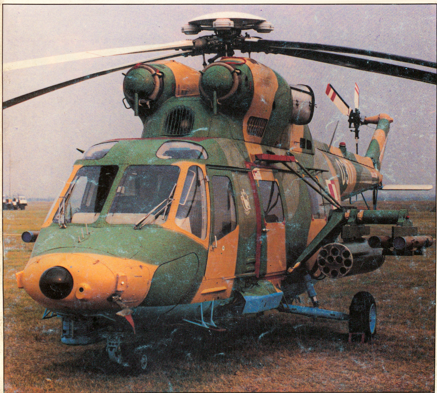
Śmigłowiec PZL Sokół w wersji uzbrojonej w dwulufowe działko GSz-23 kal. 23 mm (z lewej strony, u dołu kadłuba) oraz w dwie wyrzutnie B8-10 niekierowanych pocisków rakietowych S-8 kal. 80 mm (na belkach bliżej kadłuba) i cztery wyrzutnie pocisków kierowanych 9M114 kal. 130 mm. Zdjęcia szczegółów w numerze
