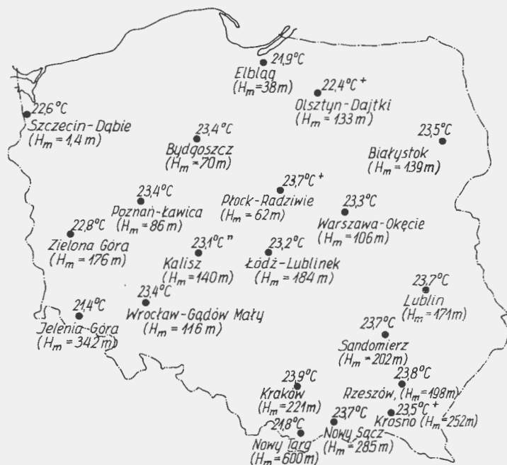
Rys. 5. Średnie ze średnich miesięcznych dziennych maksymalnych temperatur lipca (temperatury referencyjne) w latach 1954 ÷ 1963. H_m – położenie stacji meteorologicznej n.p.m. Na podstawie [10]: + średnia z 9 lat, - średnia z 8 lat
