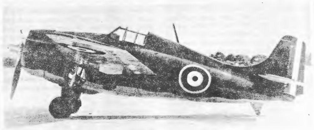
Trzeci Martlet I na lotnisku fabrycznym w Bethpage. Widoczne czarne cywilne oznaczenie samolotu na spodzie lewego skrzydła
