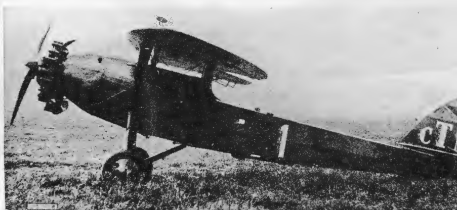
Prototyp R-XIII nr 56-1 podczas prób eksploatacyjnych w Centralnej Eskadrze Treningowej w Warszawie. Na lotkach — klapki Flettnera
