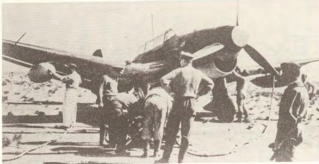
Napełnianie paliwem dodatkowych zbiorników samolotu Ju 87R-1/Trop
